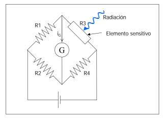
**Puente de Wheatstone.** Si R1/R2 = R3/R4  $i_G$  = 0. Si R3 cambia en valor un poco, aparece una corriente  $i_G$  proporcional al cambio.
