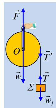
$$\text{Σώμα } \Sigma: \quad \Sigma F = m \cdot a \rightarrow mg - T = m \cdot a \quad (1)$$
