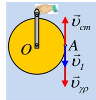
Τι σημαίνει αυτό; Ότι μεταβάλλεται και η  $v_{cm}$  και η γωνιακή ταχύτητα οπότε  $a_{cm} = a_{\gamma\omega\nu} \cdot R$ , αλλά η διαφορά  $\omega R - v_{cm}$  κάθε στιγμή παραμένει σταθερή!
