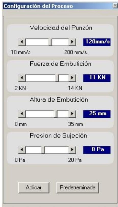
Figura 24.- Panel de configuración del proceso
