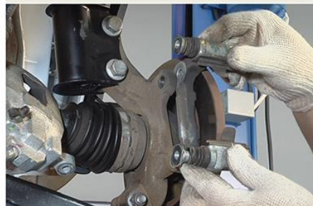
Fig.6 - Remoção do suporte da pinça de freio
