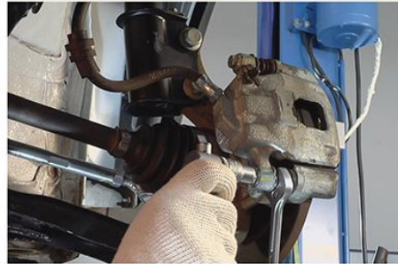
Fig.4 - Remoção dos parafusos da pinça de freio
