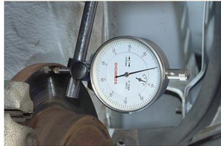
Fig.2 - Relógio comparador com pré-carga e zerado
