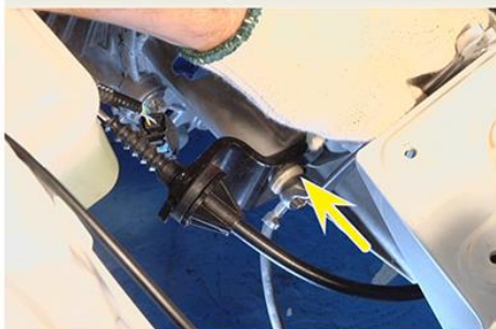
Fig.5 - Remoção do parafuso de fixação do suporte do cabo de embreagem
