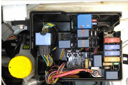
Detalhe da central de relés e fusíveis do vão do motor
