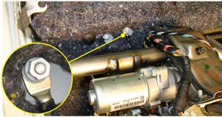
Módulo da direção assistida eletricamente (A2)
