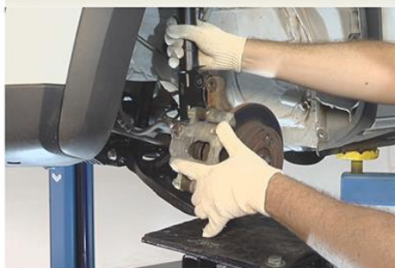
Fig.10 - Acoplamento da torre da suspensão ao suporte da manga de eixo
