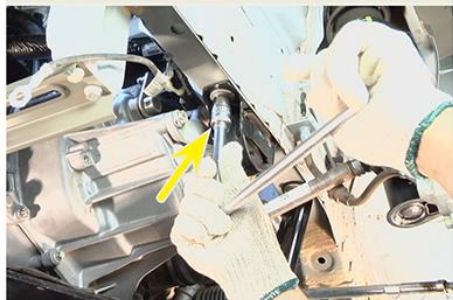
Fig.13 - Remoção dos parafusos de fixação do suporte lateral
