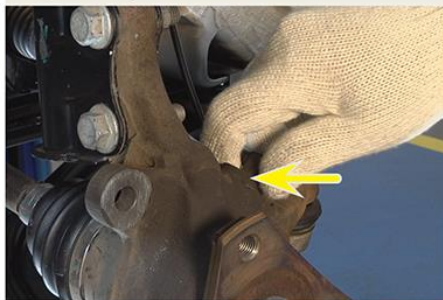
Fig.10 - Desaperto da porca de fixação do terminal de direção
