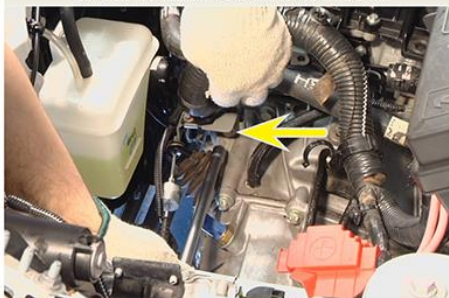
Fig.4 - Remoção do parafuso de fixação do suporte do chicote elétrico na caixa de marchas
