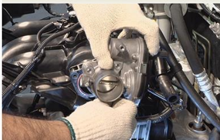
Fig.1 - Remoção da borboleta motorizada
