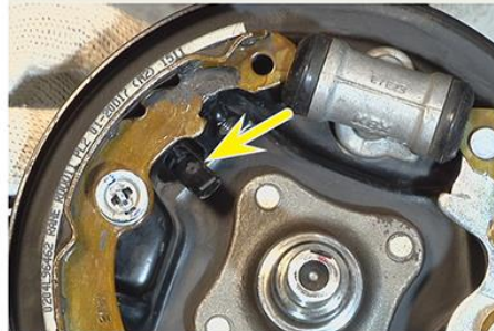
Fig.11 - Remoção do sensor ABS
