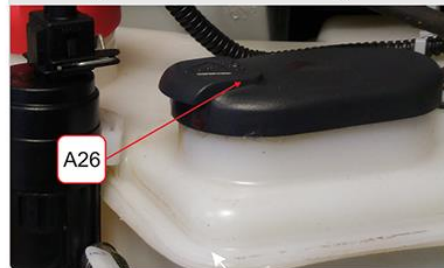
Reservatório de fluido para o Parabrisa incorporado ao reservatório de gasolina
