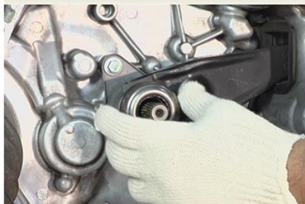
Fig.15 - Remoção do colar da embreagem
