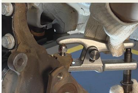
Fig.11 - Extração do terminal de direção
