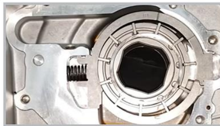
Sistema de bomba de óleo de vazão variável
