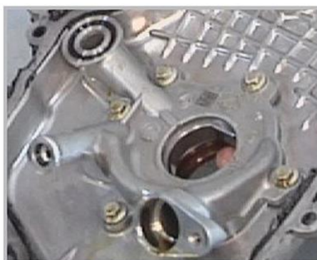
Bomba sem controle de vazão do motor SCe
