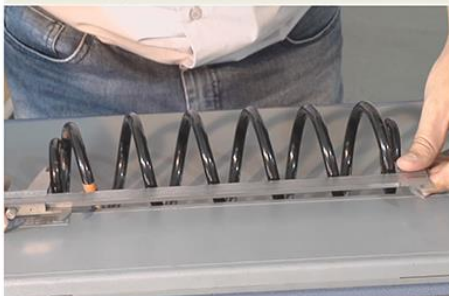
Fig.6 - Inspeção da mola da suspensão
