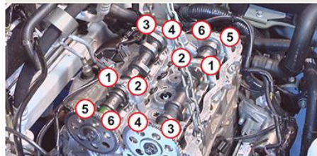
Sequência de aperto dos parafusos dos mancais dos comandos de válvulas
