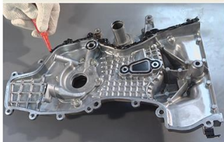
Fig.26 - Aplicação de junta líquida na tampa da corrente
