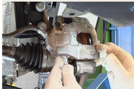
Fig.19 - Instalação da pinça de freio
