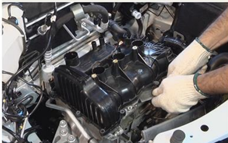
Fig.6 - Procedimento para remoção da tampa de válvulas
