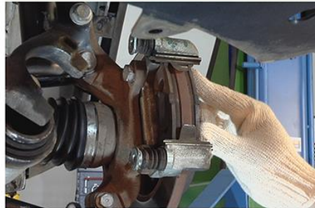
Fig.18 - Instalação das pastilhas de freio
