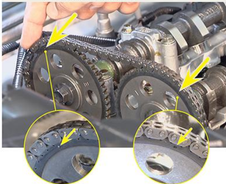
Fig.16 - Posição de referência das engrenagens dos comandos de válvulas
