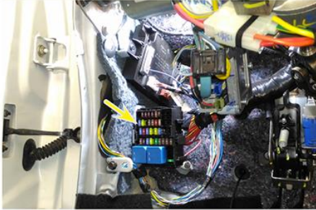
Detalhe da central de relés e fusíveis do painel
