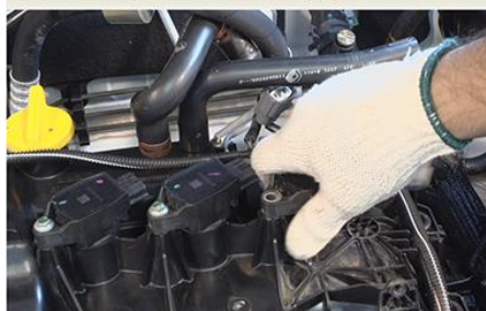
Fig.4 - Remoção das bobinas de ignição
