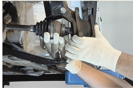
Fig.14 - Encaixe do semieixo da homocinética
