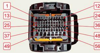
Terminal elétrico B do chicote do MC
