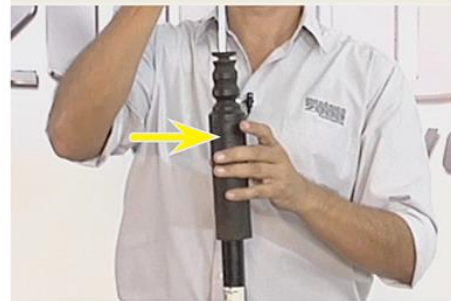
Fig.11 - Instalação do conjunto do batente com a coifa
