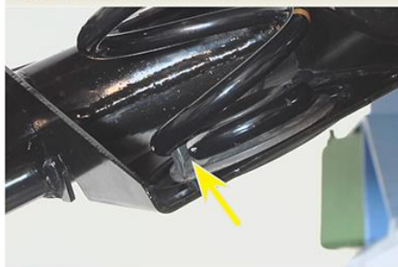
Fig.8 - Encaixe da mola no apoio inferior
