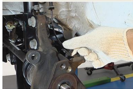
Fig.15 - Instalação do sensor ABS
