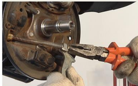
Fig.7 - Remoção do cabo do freio de estacionamento
