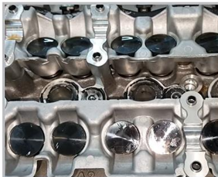
Motor SCe com tuchos revestidos em DLC
