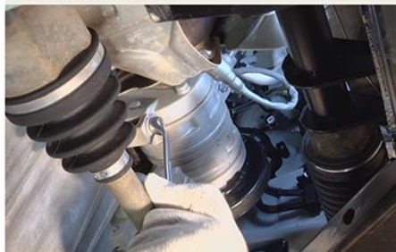
Fig.8 - Desaperto dos parafusos do compressor do ar-condicionado
