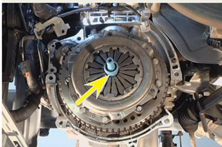
Fig.17 - Ferramenta de centralização do disco inserida
