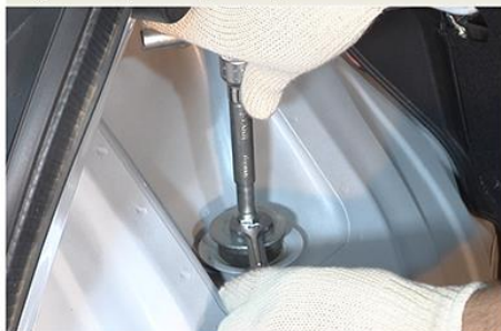
Fig.1 - Desaperto da porca superior do amortecedor
