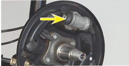
Fig.8 - Inspeção do cilindro de freio
