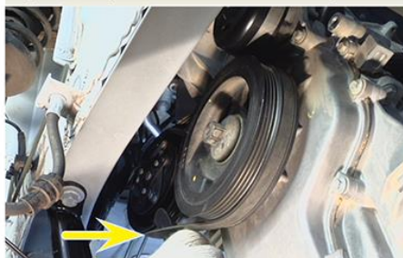
Fig.9 - Remoção da correia micro-V do compressor
