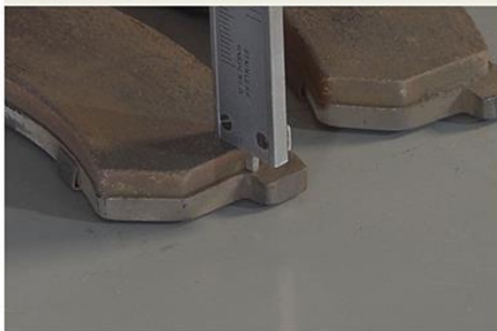
Fig.17 - Inspeção das pastilhas de freio
