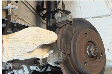
Fig.5 - Remoção das pastilhas de freio
