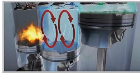
Turbulência dentro da câmara durante a admissão (Tumble)
