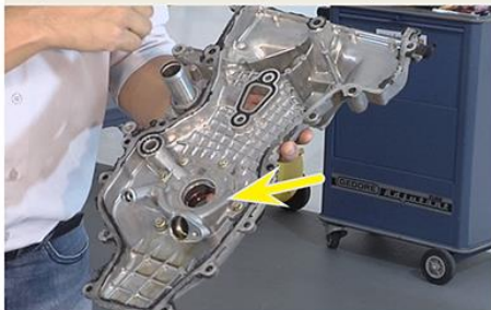
Fig.15 - Bomba de óleo acoplada à tampa da corrente
