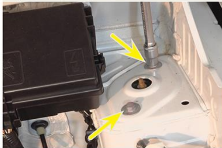
Fig.1 - Remoção dos parafusos superiores da torre
