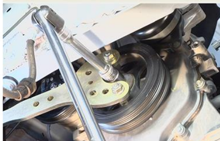
Fig.10 - Remoção da polia da árvore de manivelas
