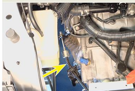
Fig.19 - Cabo da embreagem instalado
