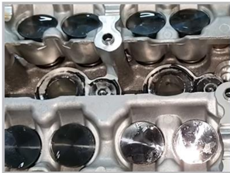
Detalhe dos tuchos das válvulas com DLC
