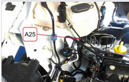
Tubo de recalque da bomba
