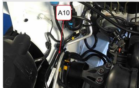
Tubo de vapor do reservatório de gasolina do sistema de partida a frio
