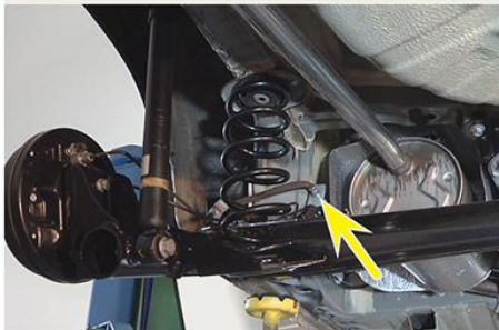
Fig.5 - Cabo do conduíte de freio
