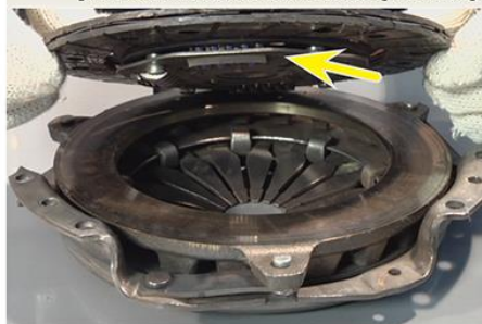
Fig.16 - Acoplamento do disco à chapa de pressão - parte com ressalto do disco voltada para a chapa
