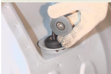
Fig.2 - Remoção da arruela de retenção
