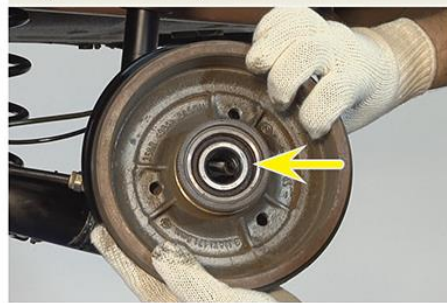
Fig.3 - Rolamento acoplado ao tambor de freio
