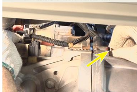
Fig.11 - Remoção do parafuso inferior de fixação do motor de partida à caixa de marchas
