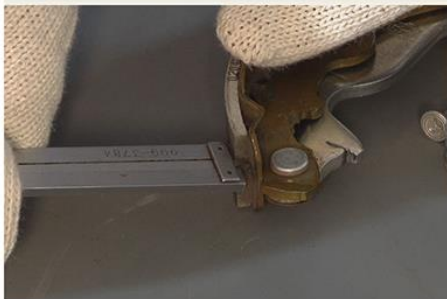
Fig.9 - Medição da espessura das lonas das sapatas
