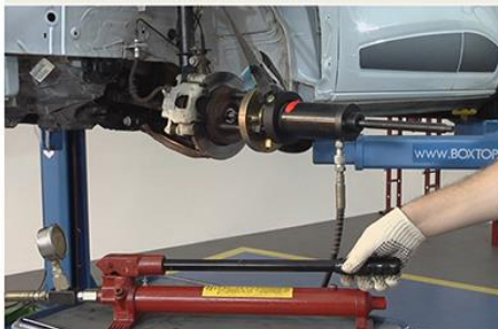
Fig.8 - Conjunto de ferramentas instalado para a extração do semieixo da homocinética
