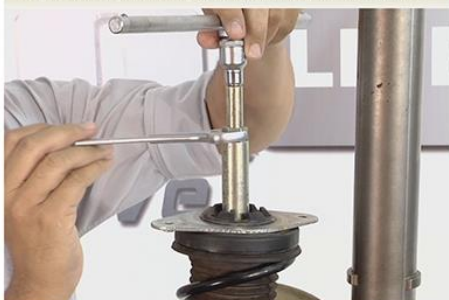
Fig.5 - Desaperto da porca da haste do amortecedor
