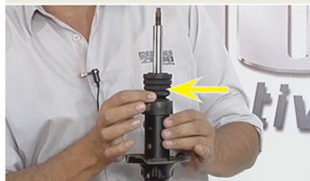
Fig.6 - Batente instalado - menor diâmetro para baixo
