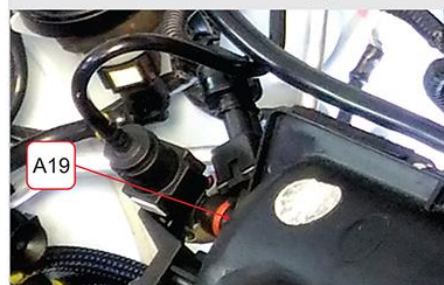
Detalhe do local de injeção
