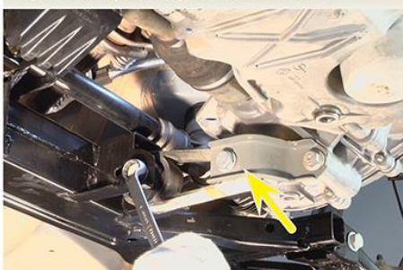
Fig.10 - Remoção do suporte inferior da caixa
