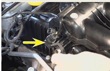
Fig.3 - Remoção da válvula de corte de combustível
