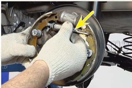
Fig.5 - Remoção da unidade de ajuste
