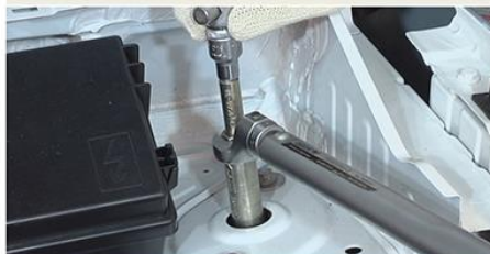
Fig.11 - Aperto da porca da haste do amortecedor
