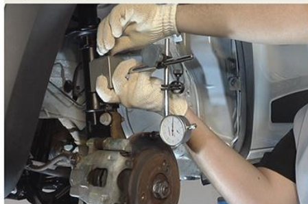
Fig.1 - Inspecção do empeno do disco de freio
