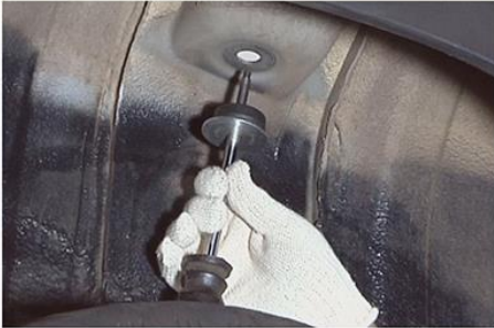
Fig.12 - Inserção da haste do amortecedor no alojamento
