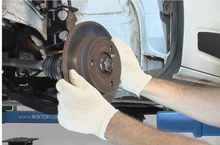
Fig.16 - Instalação do disco de freio
