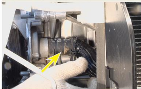
Fig.12 - Remoção da mangueira presa à tampa
