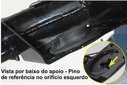
Fig.9 - Apoio inferior da mola corretamente instalado
