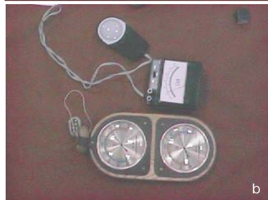
Gambar 6a: Thermohygrometer, alat untuk memonitor Kelembaban Relatif (RH), bersatuan % dan Suhu Udara (T), bersatuan °C. Gambar 6b.: Atas. Luxmeter, alat untuk memonitor kuat cahaya, bersatuan lux; Bawah. Psychrometer, alat berfungsi sama dengan Thermohygrometer.
