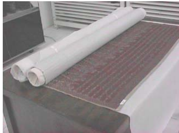
Gambar 11: Sistem roling adalah cara yang ideal untuk penyimpanan tekstil, untuk menghindari patahnya benang logam atau sobek karena seringnya dilipat.
