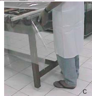
Gambar 4b: Tekstil diletakkan diatas kasa plastik yang kedua ujungnya dipasang tongkat kayu. Tongkat kayu ini berfungsi sebagai pegangan pada saat mengangkat kain. Gambar 4c: Meja kayu yang ringan ini dapat diangkat, sehingga mempermudah pengeringan bak cuci.
