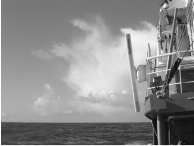
Abb. 1: Vertikalradar (10 kW) an der Reling des Forschungskutters „Uthörn“ des Alfred-Wegener-Instituts für Polar- und Meeresforschung (Länge über alles: 30,5 m, Radargerät etwa 4 m über der Wasseroberfläche). Vertically working ship-radar on board the Research Vessel „Uthörn“ (Length: 30.5 m, radar c. 4 m above the water surface). Foto: O. Hüppop
