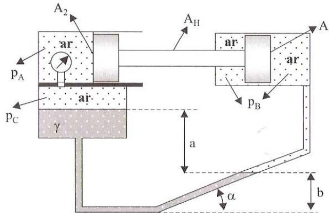
5. (P2.19, Brunetti) No manômetro da figura, sabe-se que, quando a força  $F$  é 55,6 kN, a leitura na régua é 100 cm. Determinar o valor da nova leitura, caso a força  $F$  dobre de valor.
