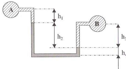
3. (P2.7, Brunetti) Calcular a leitura do manômetro  $A$  da figura.  $\gamma_{\text{Hg}} = 136\,000 \text{ N/m}^3$ .
