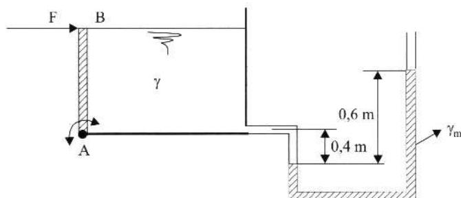
2. (P2.25, Brunetti) A comporta  $AB$  da figura tem 1,5 m de largura e pode girar em torno de  $A$ . O tanque à esquerda contém água. ( $\gamma = 10\,000 \text{ N/m}^3$ ) e o da direita, óleo. ( $\gamma = 7\,500 \text{ N/m}^3$ ). Qual é a força necessária em  $B$  para manter a comporta vertical?
