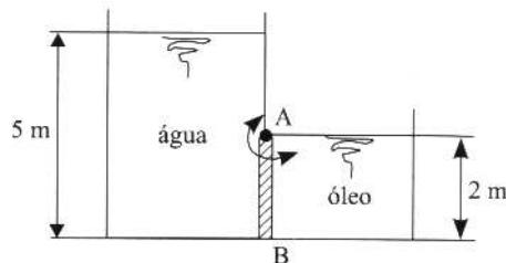
3. (P2.27, Brunetti) Determinar a força devida a pressão da água, na comporta retangular da figura, sendo o peso específico do fluido  $10\,000 \text{ N/m}^3$ .
