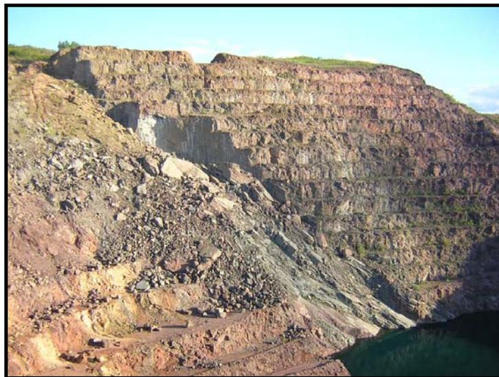
Figura 30: Escorregamento translacional com superfície de ruptura na interface da solo-rocha, ocorrida na mina de Camaquã em meados de 2006.
