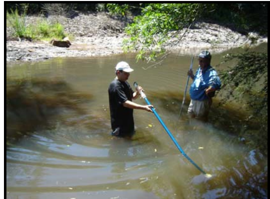
Uso do medidor de vazão para medir a vazão do rio.
