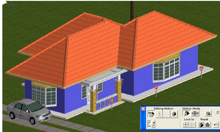
Gambar 1.12 Tampilan gambar isometri yang sudah dimodifikasi dengan perangkat 3D Navigation Palette
