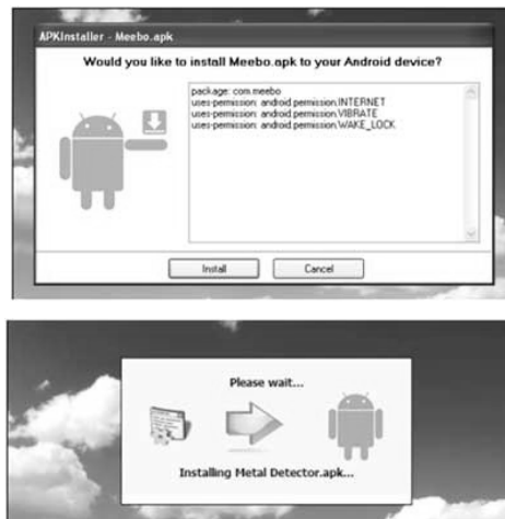
Gambar 1.54 Instalasi menggunakan APK Intaller
