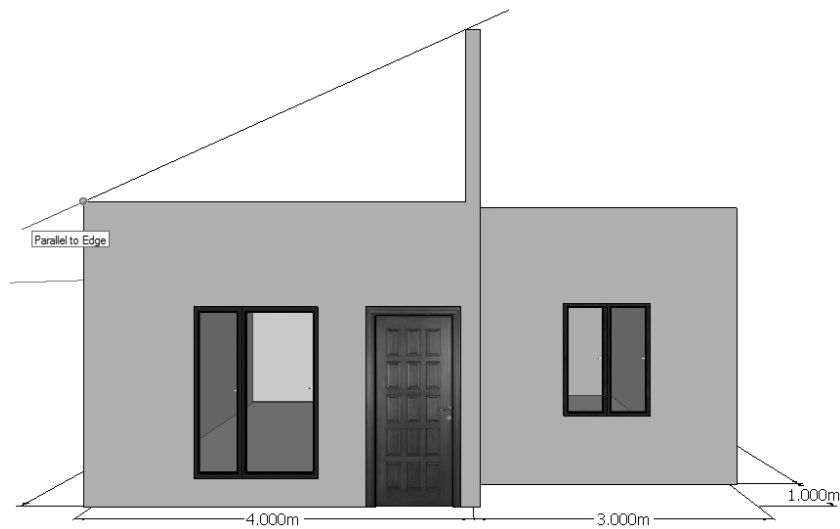
Gambar 3.27 Merancang atap setengah pelana
